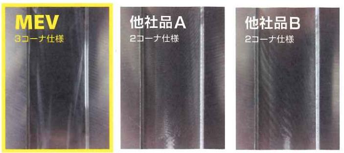
SUS430 Vc=220m/min fz=0.1mm/t ap=3mm, wet 加工径φ20, 突出L60mm
