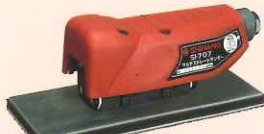
SI-7100 マルチストレートサンダー ペーパーサイズ: 75×175mm ストローク長: 5mm 全長: 143mm 質量: 0.5kg
