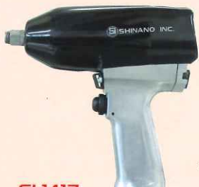
SI-1417 12.7mm 角インパクトレンチ 能力ボルト径: 16mm 最高トルク: 400Nm 全長: 190mm 質量: 2.5kg
