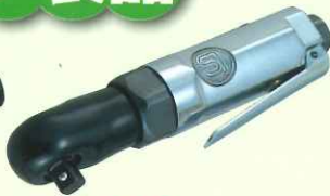
SI-1209 9.5mm 角ミニラチェットレンチ 能力ボルト径: 10mm 無負荷回転数: 250r.p.m. 全長: 167mm 質量: 0.55kg
