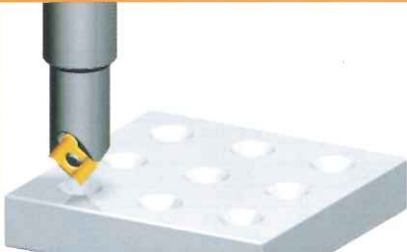
センターリング加工
